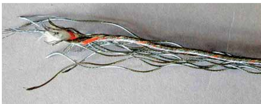
Abbildung 9: Beschädigtes Verbindungsmittel (Stahldrahtseil)
