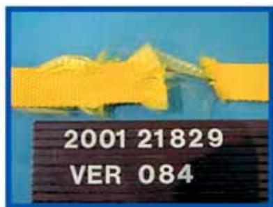
Abbildung 7: Gerissenes Verbindungsmittel (Gurtband)
