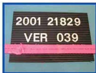
Abbildung 8: Beschädigte Verbindung (gedrehtes Chemiefaserseil)
